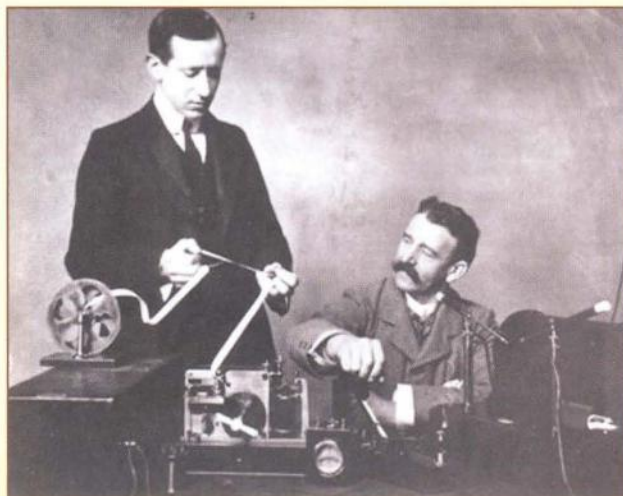
Obr. 2. Marconiho přijímač s kohererem (detektorem) vytažený ze skříňky, která přijímač určitou dobu chránila před očima jiných vynálezců
