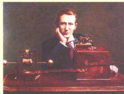
Obr. 1. Marconi u své aparatury r. 1896/197. Přijímač je umístěn ve skřínce, kde se nachází kohererový přijímač podobný tomu, co použil Popov. Náhoda?
