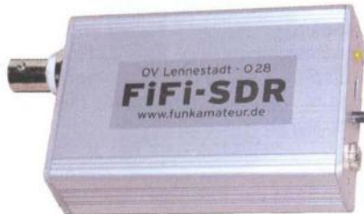
Přijímač FiFi-SDR je v pouzdře o rozměrech 110x50x24 mm
