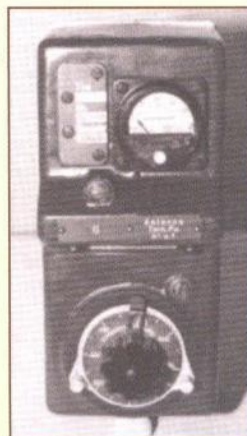
Obr. 8. anténní člen Abst.a ke stanicím Torn.Fu
