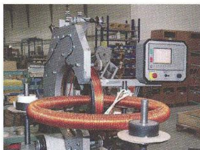
Vinutí proudového měřicího transformátoru 50 kVA/50 A
